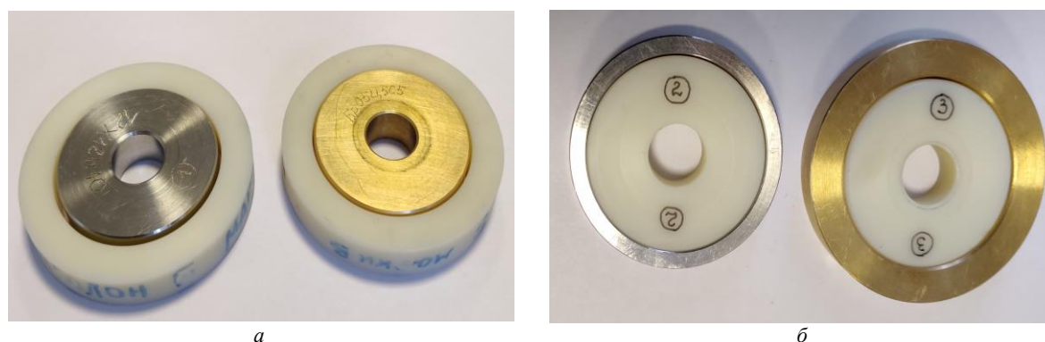
Рис. 2. Фото обратных (а) и прямых (б) пар трения: слева на каждом фото – сопряжения нержавеющей стали и капролона, справа – оловянистой бронзы и капролона
