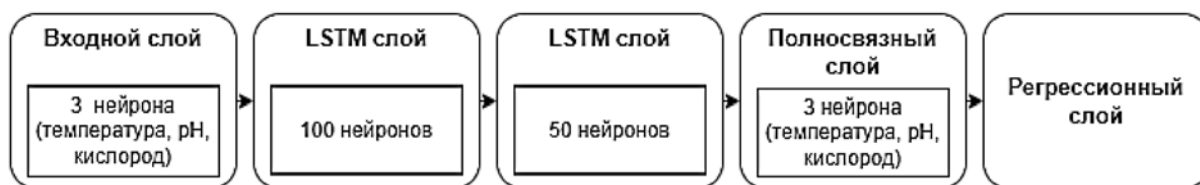
Рис. 5. Архитектура модели прогнозирования параметров воды
