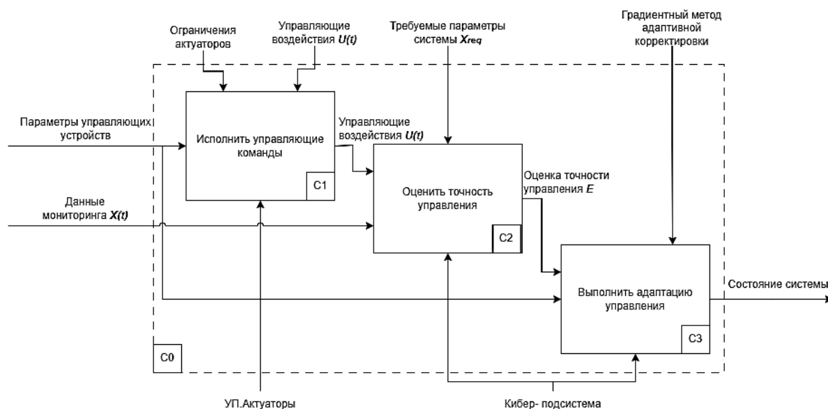
Рис. 7. Метод управления киберфизической системой на основе данных мониторинга
