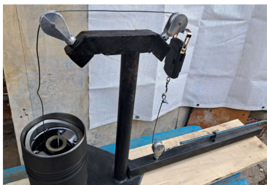
Рис. 4. Общий вид стенда для замера силы трения
